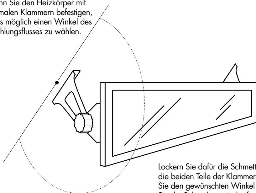
Lockern Sie dafür die Schmetterlingschrauben, die beiden Teile der Klammen verbinden, stellen Sie den gewünschten Winkel ein und schrauben Sie die Schrauben wieder fest.
