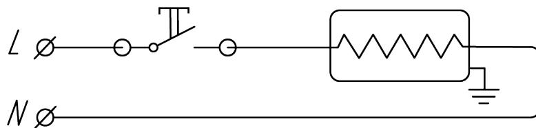
Schéma 1. Schéma de la connexion de l'interrupteur
