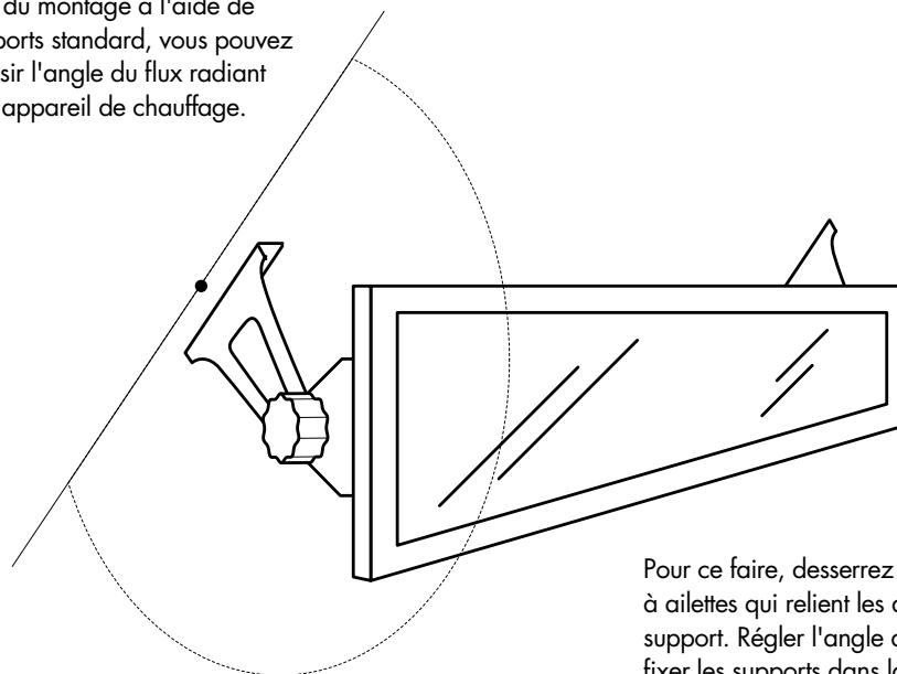
Pour ce faire, desserrez légèrement les boulons à ailettes qui relient les deux parties de chaque support. Réglér l'angle désiré de l'instrument et fixer les supports dans la position sélectionnée.
