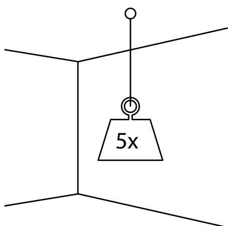
La résistance du plafond ou de la conception pour laquelle les appareils de chauffage sont montés doit être suffisante pour supporter cinq fois la masse de l'appareil.
