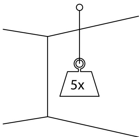
Прочность потолка, либо конструкций, на которые крепится обогреватель, должна быть достаточной, чтобы выдержать 5-кратную массу обогревателя.
