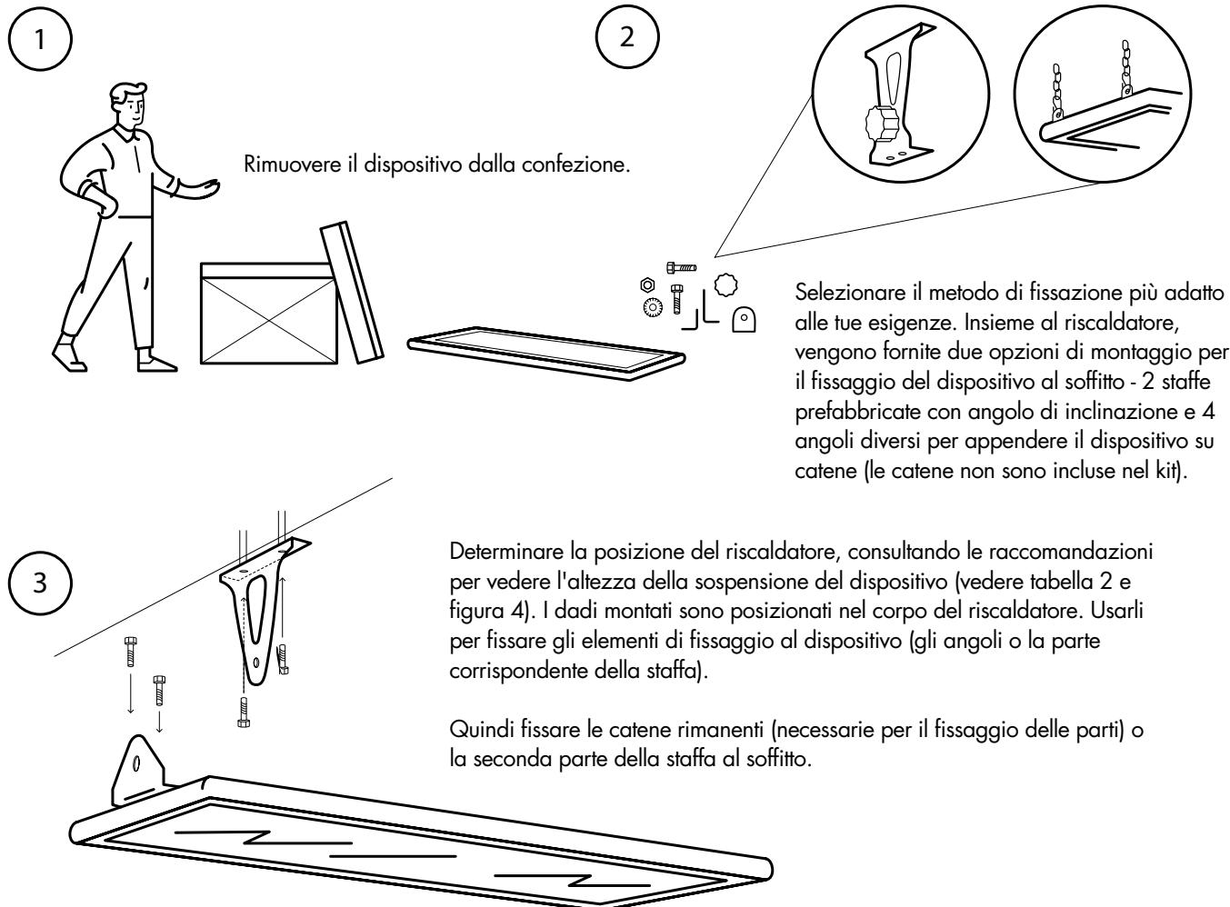
Figura 2. Installazione del riscaldamento a soffitto ThermoUp Top
