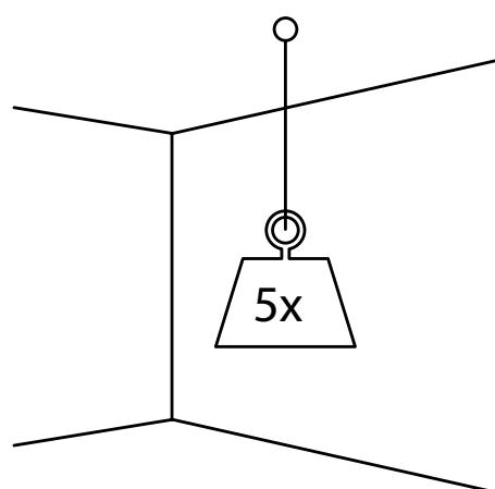
La resistenza del soffitto o del design per cui sono montati i riscaldatori deve essere sufficiente a sopportare cinque volte la massa del riscaldatore.
