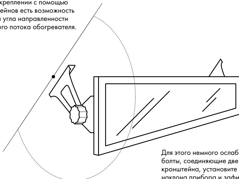
Для этого немножко ослабьте барашковые болты, соединяющие две части каждого кронштейна, установите необходимый угол наклона прибора и зафиксируйте кронштейны в выбранном положении.
