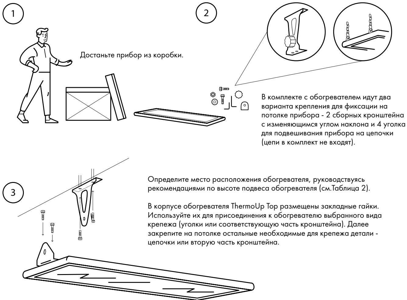
Рисунок 2. Монтаж обогревателя ThermoUp Top
