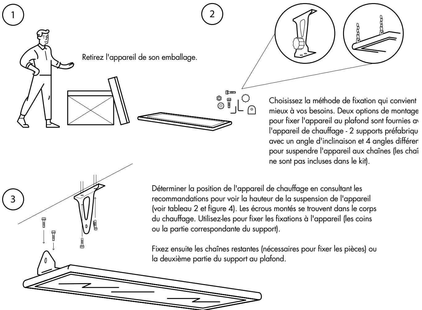
Figure 2. Installation du chauffage au plafond ThermoUp Top
