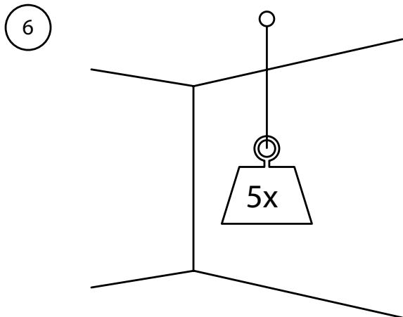
Die Oberfläche auf der der Heizkörper montiert wird muss dem fünffachen Gewicht des Heizkörpers standhalten können.
