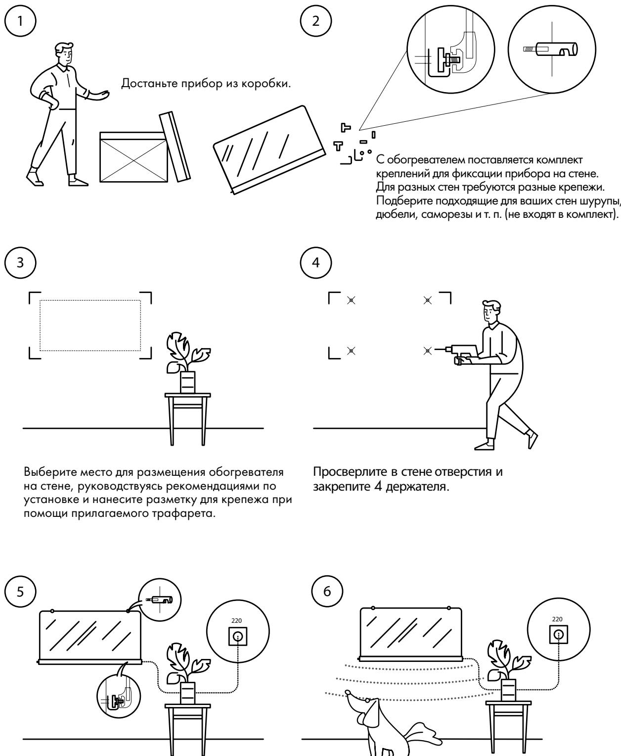
Выберите место для размещения обогревателя на стене, руководствуясь рекомендациями по установке и нанесите разметку для крепежа при помощи прилагаемого трафарета.
